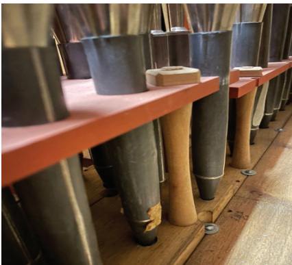
Bild links: Die Stiefel der Zungenpfeifen weisen Korrosionsschäden auf.
